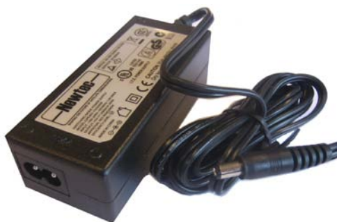
Afbeelding 3 – Stroomtoevoer van de IP-modem
